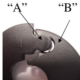
Per accoppiare le due semiflangie, appoggiarle sull'asta tenendole inclinate in modo che la protuberanza "A" si trovi davanti all'incavo "B" quindi portarle in verticale esercitando una leggera pressione.
